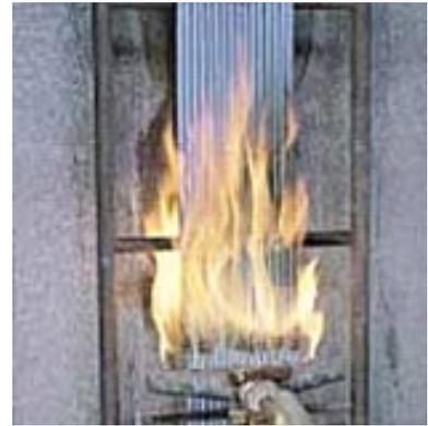
EN 50266-2-3:2001/BS EN 50266-2-3:2001/DIN EN 50266-2-3:2001/VDE 0482-266-2-3:2001-09标准的试验方法是在着火条件下，常用的阻燃试验方法。该试验是对垂直安装的成束电缆的垂直火焰蔓延的阻燃测试。)
