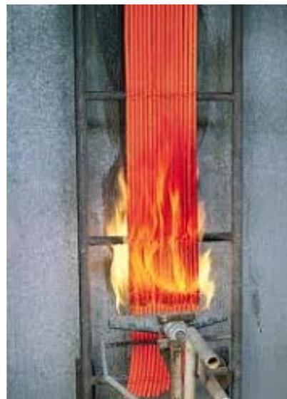
EN 60332-3-21:2009/BS EN 60332-3-21:2009/IEC 60332-3-21 ed1.1/DIN EN 60332-3-21/VDE 0482-332-3-21:2010-08—该标准试验是在着火条件下对电缆常用的测试方法。该试验是着火条件下，电力电缆和光纤电缆的试验。第3-21部分是对垂直安装的成束电缆的垂直火焰蔓延试验 A F/R 类
